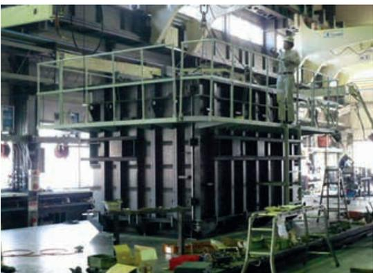
图 5、6：一个预制厕所的模具和混凝土制品
